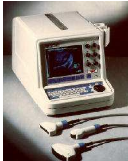
Obrázek 35: Ultrazvukové vyšetření a ultrazvukový přístroj se sondami.
