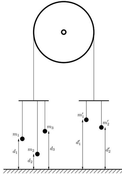
Soustava má jediný stupeň volnosti daný otáčením kladky. Označme jako  $x$  výšku levého háku nad bodem, kdy jsou oba háky ve stejné výšce – tedy pro  $x = 0$  jsou oba háky ve stejné výšce a pro  $x > 0$  bude levý hák o  $2x$  výšce než pravý hák. V závislosti na  $x$  každé závaží buď visí nad zemí (pak je jeho potenciální energie rovna  $m_i$  krát výška nad zemí) nebo leží na zemi (pak je jeho potenciální energie nulová). Soustava bude v rovnováze při minimální celkové potenciální energii.
