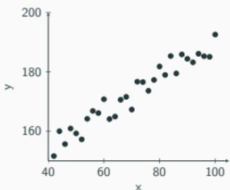
Soustava lineárních rovnic  $y_i = \theta_1 + \theta_2 x_i$ ,  $i = 1, \dots, m$ ,
