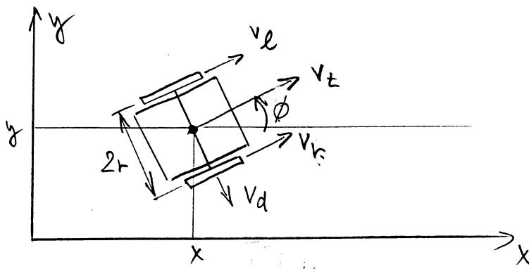
stav robotu:  $(x, y, \phi, \dot{v}_r, \dot{v}_e)$  kde  $v_r = k_r \cdot \omega_r$
