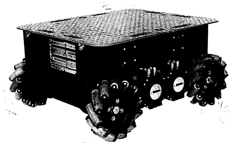
$$v_y = \frac{1}{4} (v_0 + v_1 + v_2 + v_3) \quad \text{dopředná rychl.}$$
