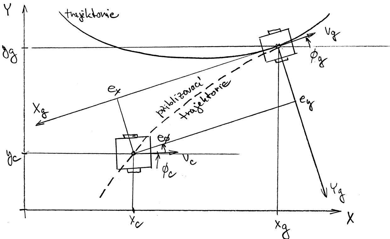
→ určení odchylky robota od cílové polohy
