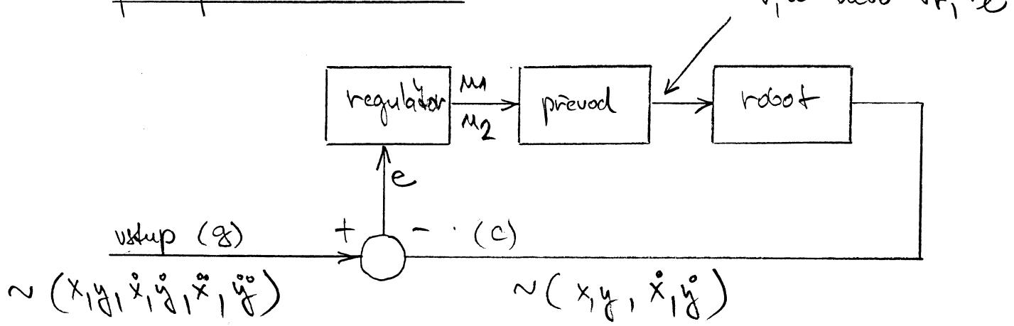
► Vzhledem k dimenzi systému vede řešení většinou na stavový regulačor (sudnější dosažení požadovaného chování a stability)
