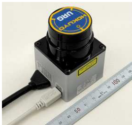
Malý laserový hloubkoměr firmy Hokuyo. Malý dosah max. 6m
