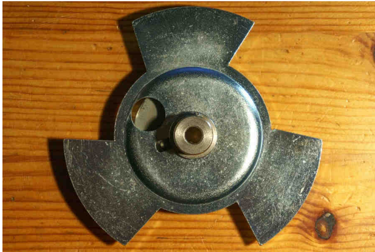
Obr. 1 Původní závěrka v promítačce Meopta Meos Duo.
