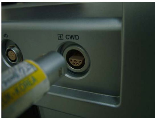
Obrázek 1-20. Před vložením do portu zarovnejte konektor s portem sondy.
