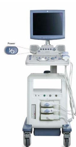
Obrázek 1-3. Umístění tlačítka napájení
