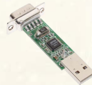
Náhrada chybějícího RS232 portu USB/RS232 redukcí na bázi čipu FT232XX
