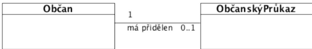
Pozn: Zatímco na jedné straně lze přiřazení protějšku provést kdykoliv v průběhu života objektu (0..1), druhá uvedená násobnost (1) jasně stanovuje podmínu, že protějšek musí být přidělen hned při vzniku objektu.
