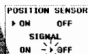
Displej v situaci, kdy je polohový senzor zapnutý (ON) a signalizace správné výše zápěstí při měření je vypnuta (SIGNAL OFF)
