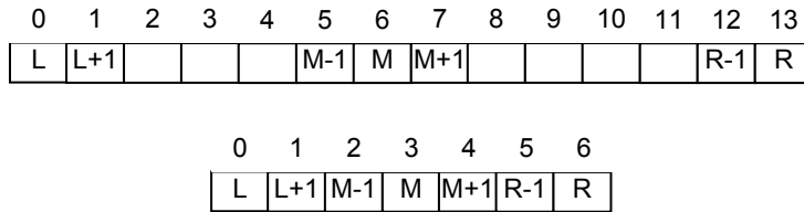
Obrázek 4 Indexy bodů, které potřebujeme pro rozhodnutí v binárním vyhledávání (zde pro 14 a 7 bodů)
